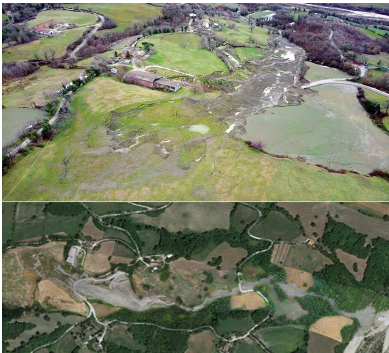
Figura 15 - L'esempio della grande frana complessa di Libiano (comune di Novafeltria) che ha travolto la strada comunale e trasportato a valle un notevole massa di fango e detriti riversati nell'alveo del fiume Marecchia.
